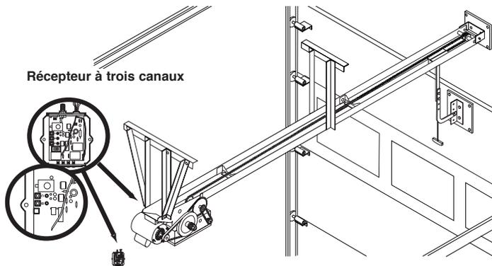
1. Utiliser un tournevis pour soulever le couvercle du récepteur (voir illustration).
