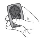
2 Ouvrir la télécommande. Tenir enfoncé le bouton de programmation jusqu'à ce que la DEL s'allume (environ deux seconds).
