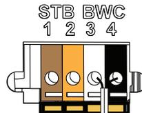
Appuyer sur les languettes orange pour insérer le fil dans les bornes 3 et 4 avec les fils de la commande murale existante
