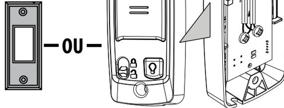
**REMARQUE :** Les fils de la commande murale acheminés à l'ouvre-porte de garage SONT sensibles à la polarité. Toujours reconnecter à la borne appropriée si le fil se déconnectait. La commande murale doit s'allumer si le câblage est correct.
