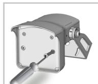
Ouvrir le détecteur seulement si le câble doit être remplacé.
