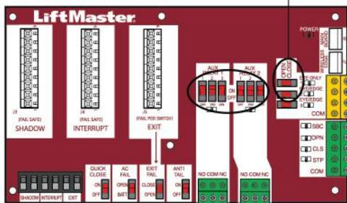
**REMARQUE :** Ces commutateurs déterminent le fonctionnement du capteur photoélectrique ou de la bordure de détection correspondant pour le cycle d'OUVERTURE ou de FERMETURE.
