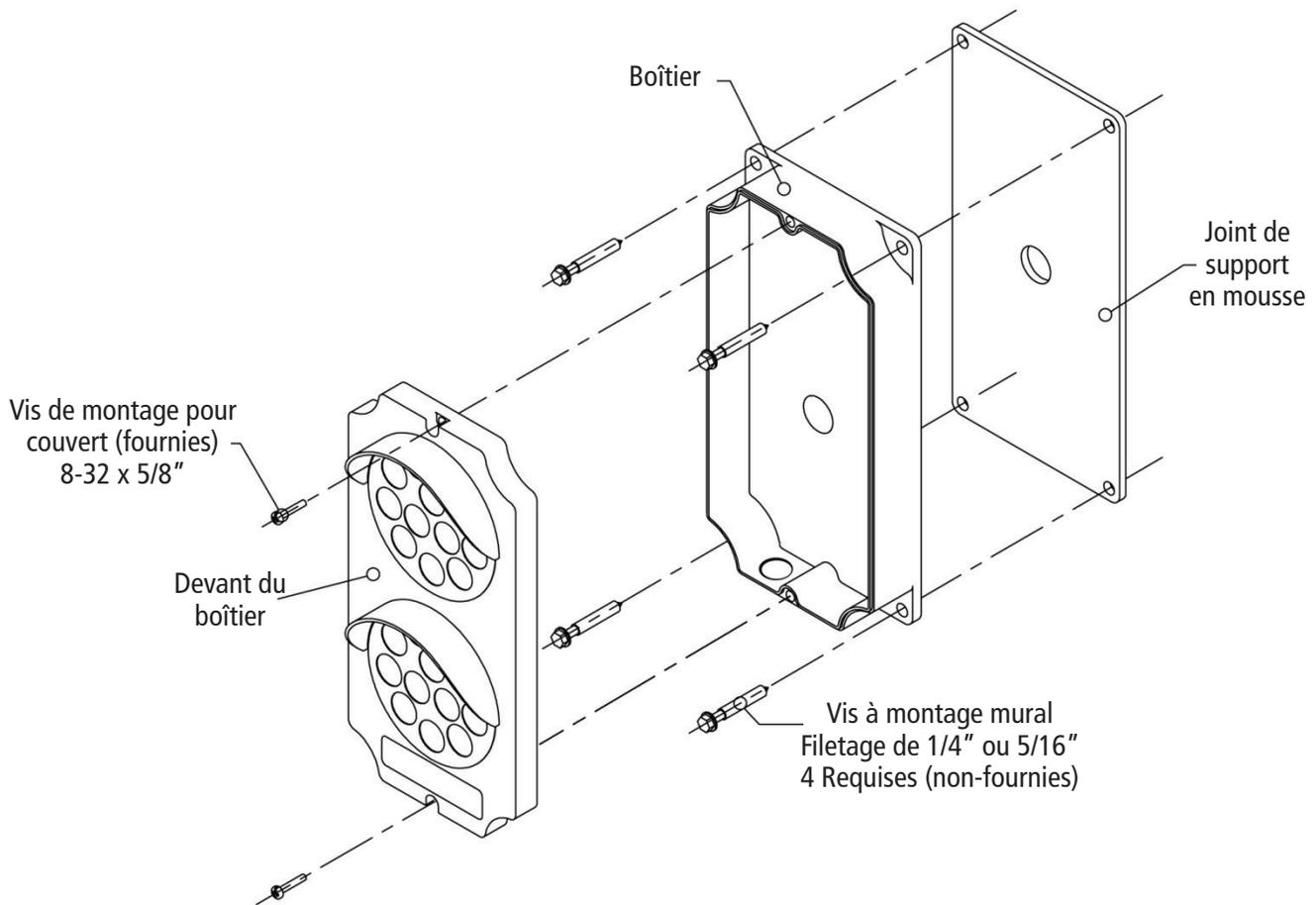
1. Démontez le devant du couvert du boîtier en retirant les deux vis de montage (5/8" acier inoxydable 8-32 filetage).
